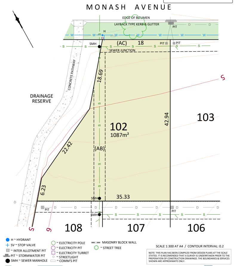
(AB) EASEMENT FOR DRAINAGE OF SEWAGE 3 WIDE
